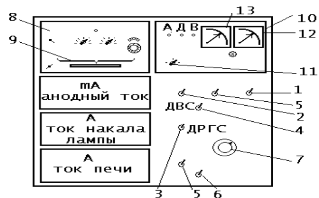
Рис.5. Передняя панель блока управления: 1-тумблер включения блока (сеть); 2, 3-тумблеры включения анода и накала лампы ДРГС-12 или ДВС-25 соответственно; 4-тумблер переключения питания на лампы ДРГС или ДВС; 5-тумблер включения печи кюветы; 6-тумблер переключения печи на режим терморегулирования или ручного управления (ЛАТР); 7-ЛАТР; 8-измерительный блок И-101; 9-переключатели установки напряжения датчика; 10-регулирующий блок Р-111; 11-переключатель режима работы Р-111; А—режим автоматического регулирования; В—выкл.; Д—режим дистанционного управления; 12-индикатор рабочего тока; 13-индикатор разбаланса.
