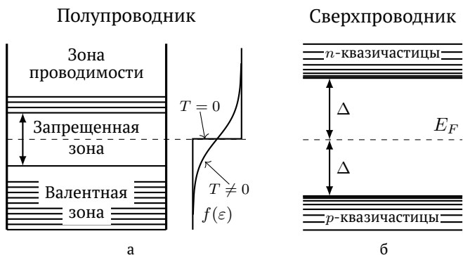
Рис. 11. Энергетические зоны электронов в чистом полупроводнике (а) и полупроводниковая модель спектра электронных ( n ) и дырочных ( p ) возбуждений в сверхпроводнике (б).
