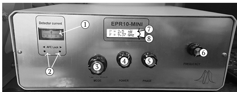
Рис. 9. Передняя панель микроволнового блока (см. рис. 9) с элементами регулировки и индикации:
